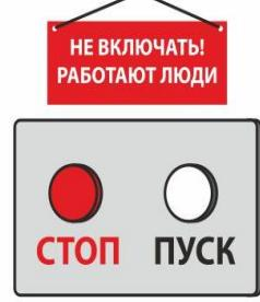
При наличии напряжения на корпусе (бьёт током) или неправильном вращении частей агрегатов, или при застревании предметов — останови машину!
